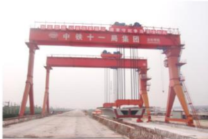
MG T L450提梁机，跨度36米，起升高度30米，应用于中铁十一局沪杭城际铁路。
