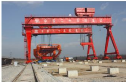
MG T L450提梁机，跨度36米，起升高度18米提梁机，应用于中铁二十五局大西铁路。
